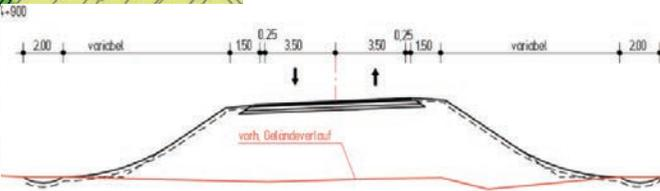
möglicher Regelquerschnitt einer Zubringerstraße zur BAB A 26
